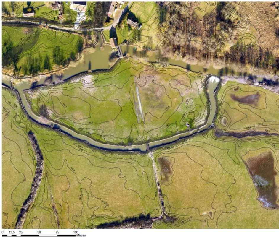
Figure 80 : Image aérienne et courbes de niveaux issues du levé Lidar du site de Hauterive
